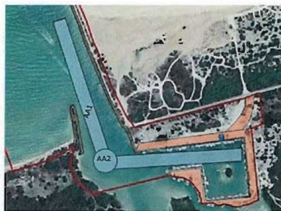
Figura 30 Obras de protección del Recinto Portuario de Chuburná
