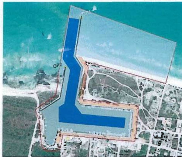
Figura 43 Áreas de agua y obras de protección del Recinto Portuario El Cuyo.
